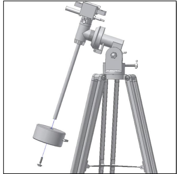
Abb. 5. Befestigen des Gegengewichts, Einschoben des Gegengewichts.
