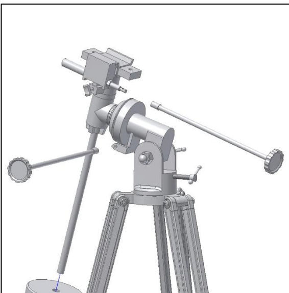
Abb. 6. Befestigen der Deklinations- und Rektaszensionsgriffe.
