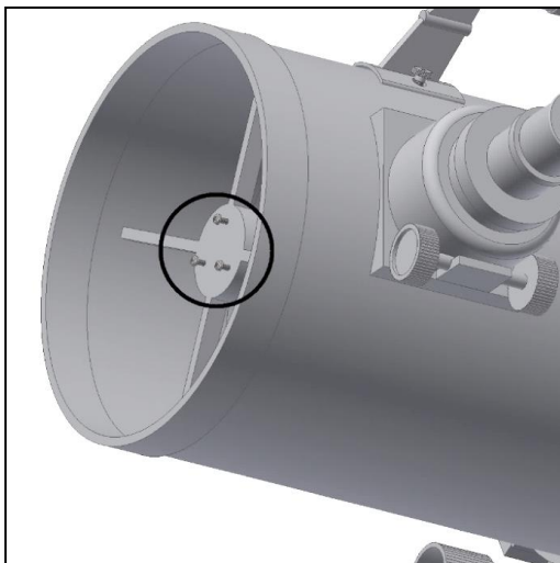
Abb. 25. Einstellschrauben des Sekundärspiegels.
